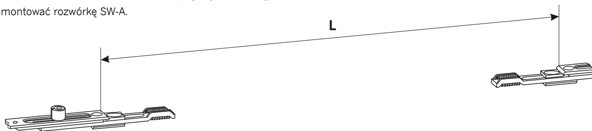
Rys. 6.2 Pomiar odległości L pomiędzy narożnikami
