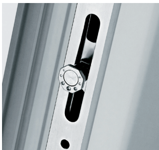
Elementy odpowiadające za bezpieczeństwo w okuciu activPilot: zaczep antywłamaniowy (na ramie okna), trzpień ryglujący w kształcie ośmiokątnego grzybka (na skrzydle).
